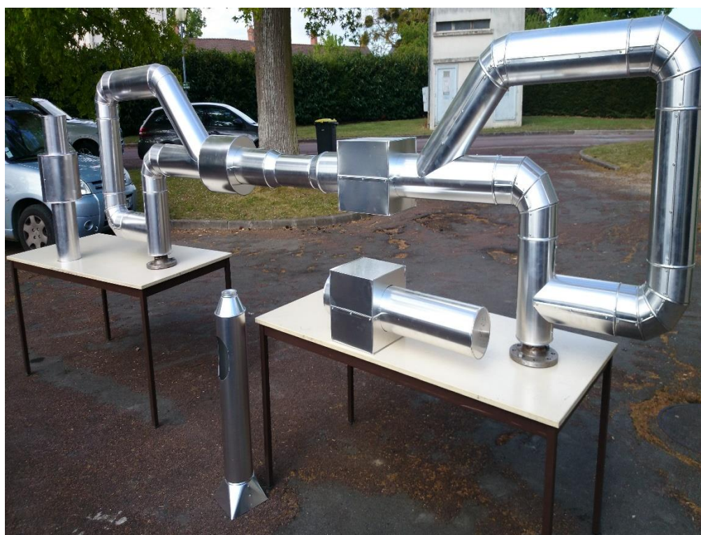
Montage Calorifugeage avec boitier gant cylindrique
