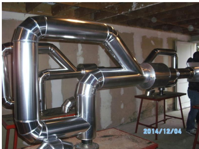
Montage Calorifugeage avec boitier gant cylindrique
